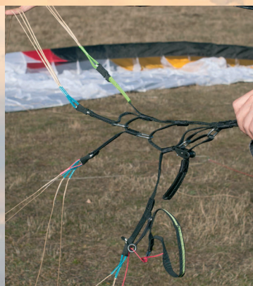
Eenvoudig maar degelijk en praktisch, de risers met trimmers op de Niviuk (Bi) Skin 2.
