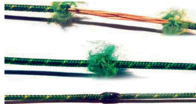
De drie stappen van het lijmen van de mantel
