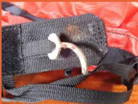
Verstopt onder de greep is roestvorming ontstaan bij de pin en ring en aangetaste sluitloop
