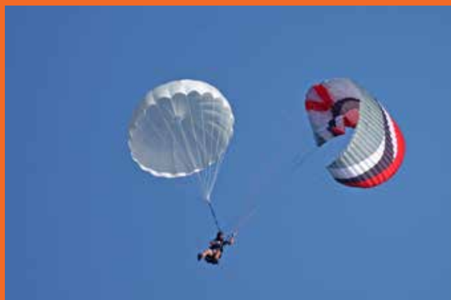
Na het werpen en openen van je reserve maak je je hoofdscherm onvliegbaar. Anders werkt deze tegen de reserve.
